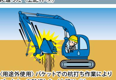
〈用途外使用〉バケットでの杭打ち作業によりバックホーを破損した(上記11-⑩)
