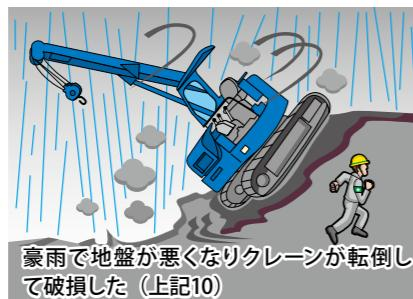
豪雨で地盤が悪くなりクレーンが転倒して破損した(上記10)
